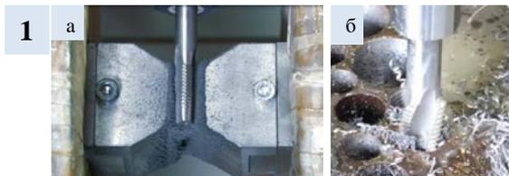
Исследования для разработки технологии производились в два этапа: а – подготовка режущих инструментов посредством МАО; б – изготовление внутренней резьбы данными инструментами
