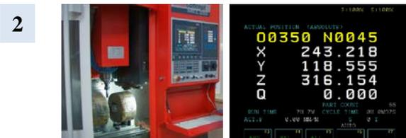
Магнитно-абразивная обработка осуществлялась на специально разработанном устройстве, который базируется на фрезерном станке с числовым программным управлением
