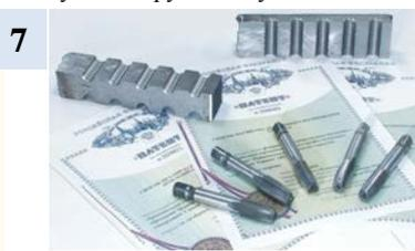
Результатами применения магнитно-абразивной обработки являются: 3 патента; шероховатость внутренней резьбы снижается в 2,1÷4,0 раза; стойкость режущего инструмента повышается в 2...2,5 раза; также снижается в 2-3 раза производственная себестоимость изготовления такого инструмента
