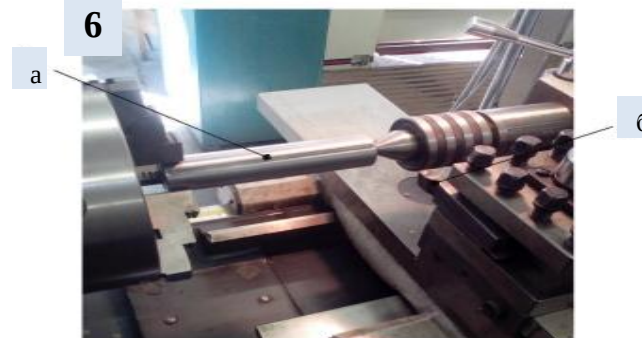
Процесс механической обработки заготовки из стали 45 с предварительно нанесенным локальным лазерным воздействием, где: а – заготовка с метастабильной структурой; б – режущий инструмент
