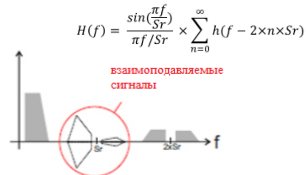
2в – Суммарный выходной сигнал ЦАП 1 и ЦАП 2
